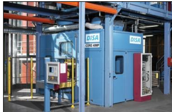
Kernschießmaschine von DiSA Volumen: 30 Liter (2024)
